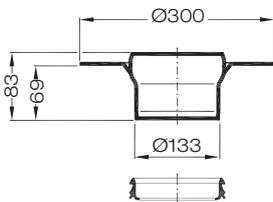
**Aufsatzelement mit Muffe**
